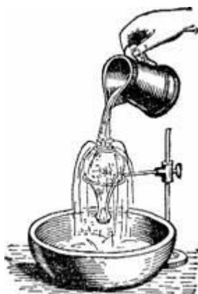
Рисунок 87. Закипание воды в колбе, обливаемой холодной водой.
