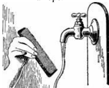
Рисунок 104. Водяная струя отклоняется при приближении наэлектризованного гребня.
