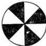
Рисунок 144. Диск для определения скорости вращения двигателя.
